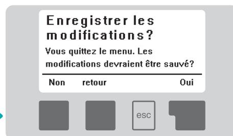
Le menu structuré offre des possibilités de consultation, d'analyse et de réglage, ainsi que des fonctions particulières telles que les commutations prioritaires, les cycles de protection et de vitesse, l'aide au démarrage pour les tubes à vide, la condensation, la fonction de pré-rinçage pour les systèmes Drain-Back, l'enregistrement des erreurs accompagné de la date et l'événement.
