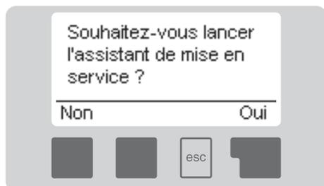
L'assistant de mise en service vous guide rapidement selon un ordre logique à travers les paramètres à définir, ce qui permet de faciliter le paramétrage et d'éviter la définition de paramètres erronés.
