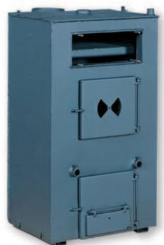
Les deux orifices d'entrée d'air primaire et d'air secondaire peuvent être facilement ajustés pour parvenir à une bonne combustion et pour allonger le temps de combustion ainsi que l'autonomie. Bien que les surfaces de transfert de chaleur s'encrassent peu, la chaudière est équipée d'une porte spéciale pour un nettoyage facile.
