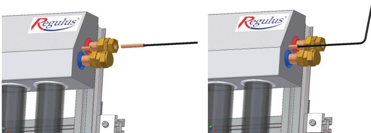
Fig. 26: Insertion d'une sonde de température
