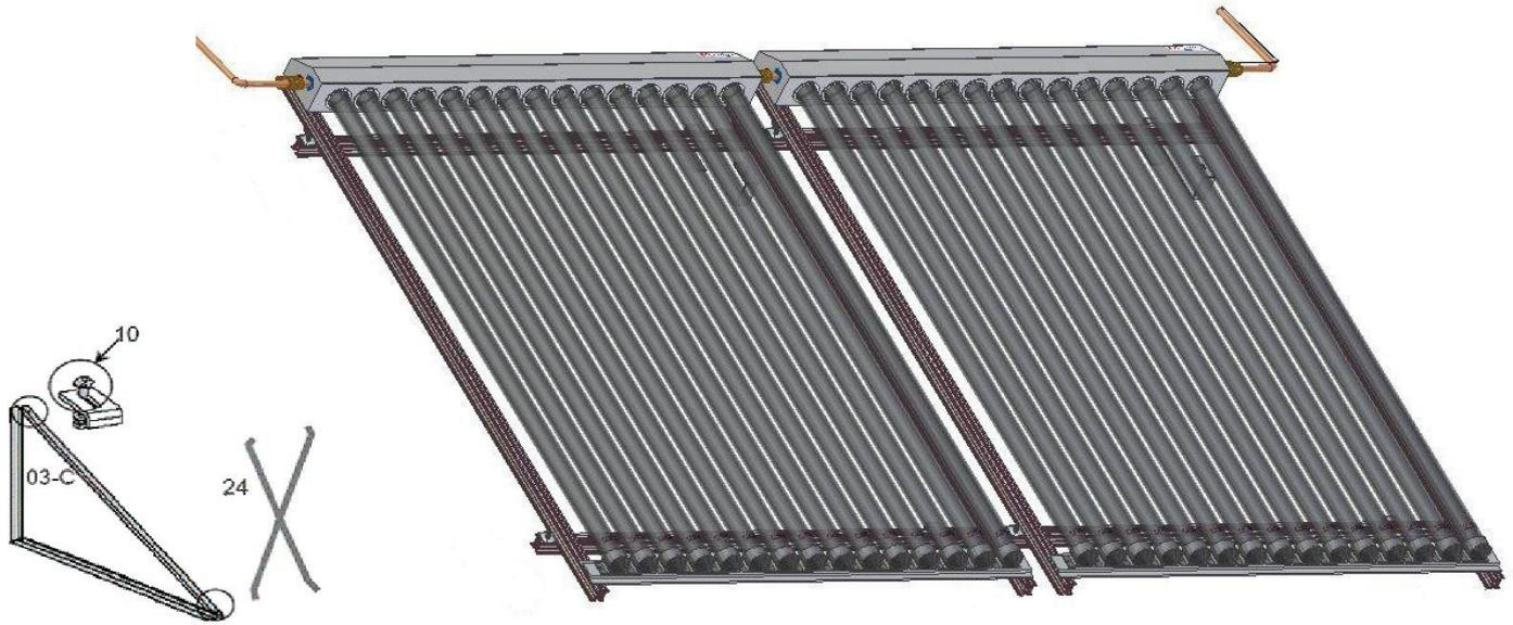
Fig. 14 : Equerre de support et traverses de sûreté
