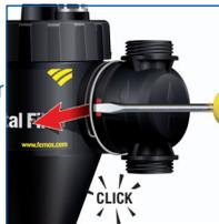
2. Écarter l'orifice d'entrée/sortie du corps d'environ 3 mm pour permettre la rotation à la position voulue.
