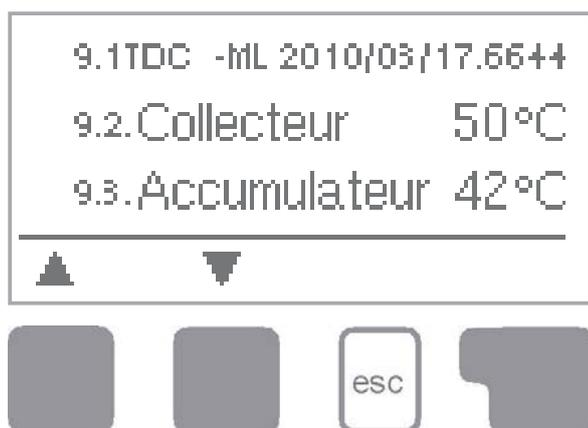
Le menu « 9. Valeurs SAV » permet, en cas d'erreur, au technicien spécialisé ou au fabricant à procéder p. ex. à un diagnostic à distance.
