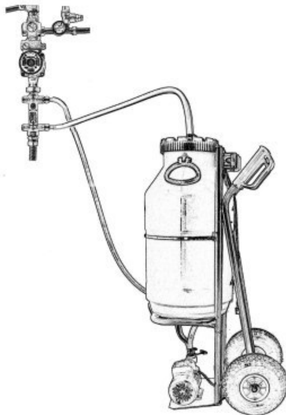
Fig. 31 : Remplissage d'un système solaire
