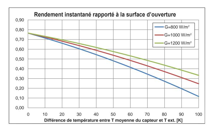
La puissance du capteur KPW2-C32HTF au point 0 pour G=1000 W/m² est de 1536 W
