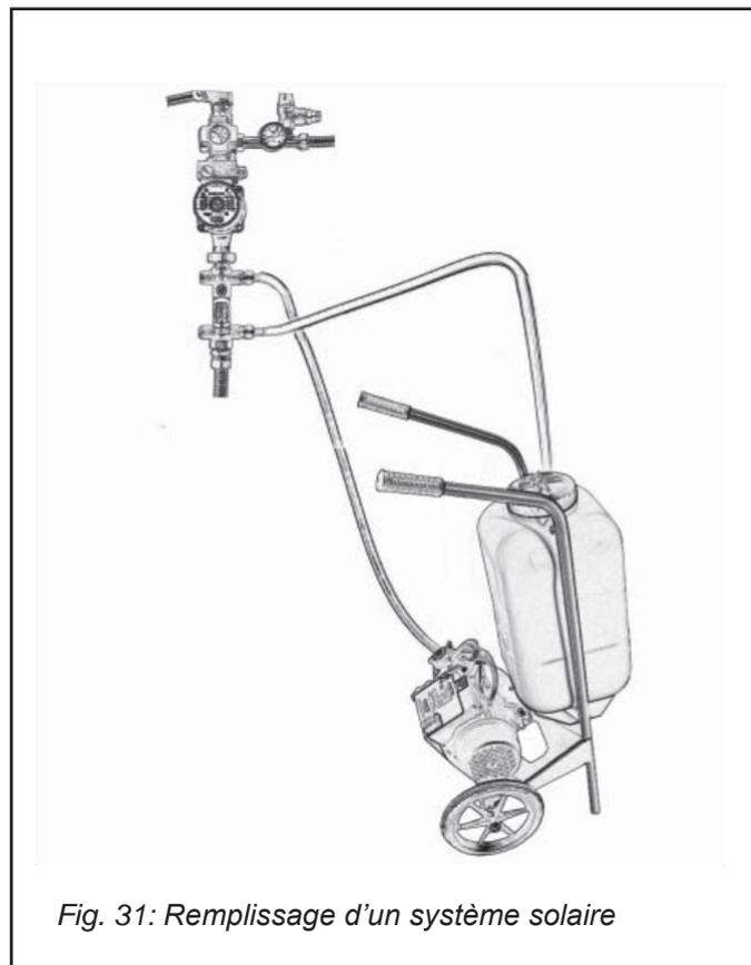
Fig. 31: Remplissage d'un système solaire
